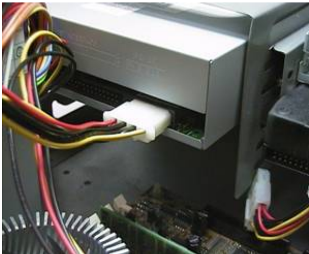
Figura 11.69 - Ligando o drive de CD-ROM na fonte de alimentação.
