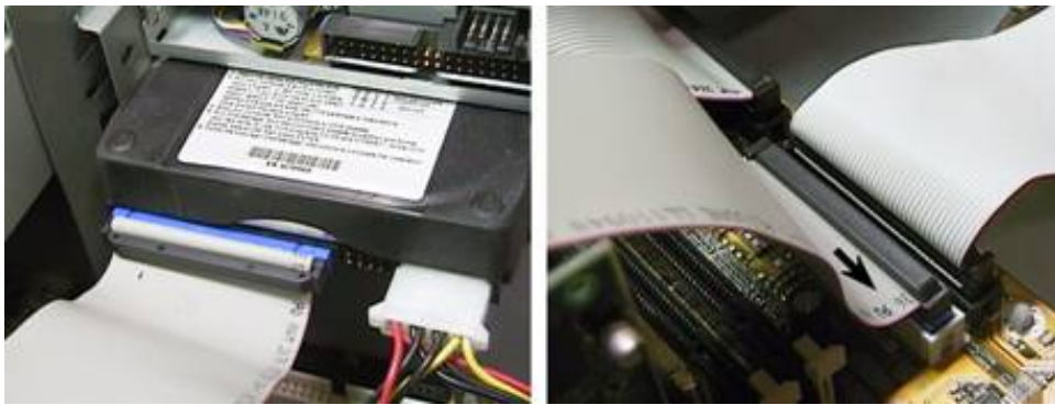
Figura 11.72 - Conectando o disco rígido na sua interface.
