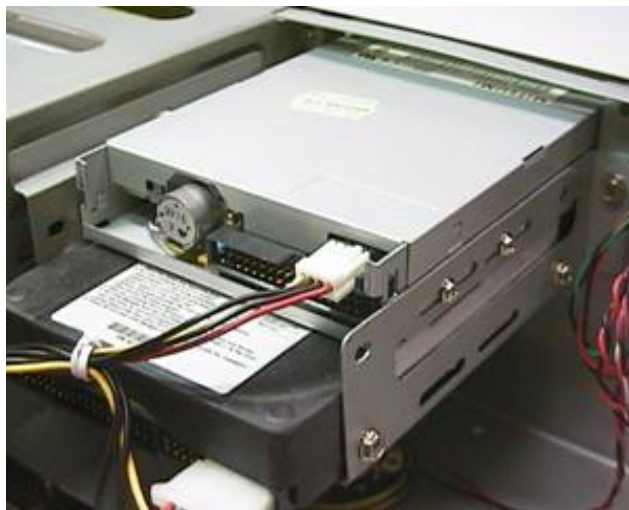
Figura 11.70 - Ligando o drive de disquetes na fonte de alimentação.
