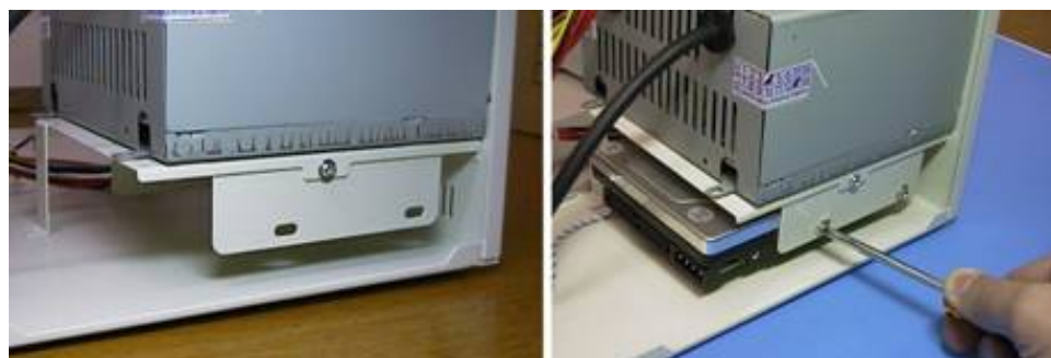
Figura 11.58 - Montando o disco rígido sob a fonte de alimentação.
