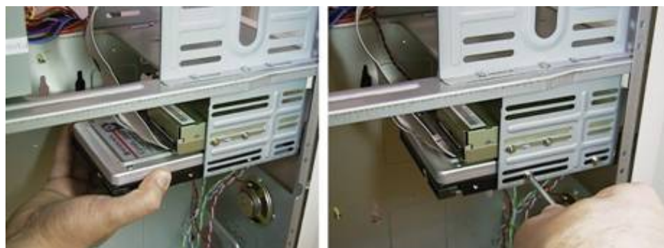
Figura 11.54 - Montando o disco rígido em um gabinete torre.
