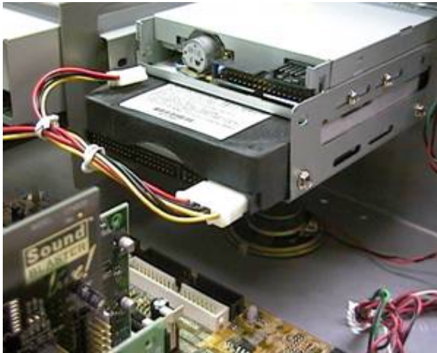
Figura 11.68 - Ligando o disco rígido na fonte de alimentação.
