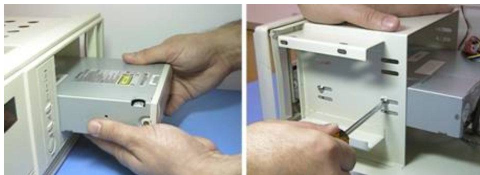
Figura 11.56 - Montando o drive de CD-ROM em um gabinete horizontal.
