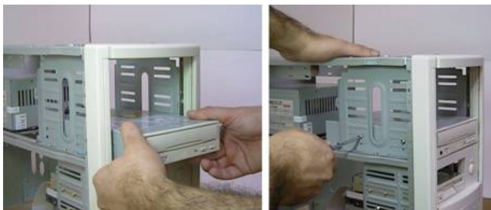
Figura 11.52 - Fixando o drive de CD-ROM em um gabinete torre.
