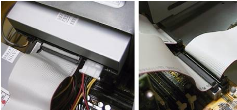
Figura 11.73 - Conectando o drive de CD-ROM na sua interface.
