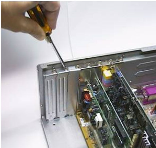
Figura 11.65 - Use as tampas metálicas para fechar as fendas sem uso no gabinete.
